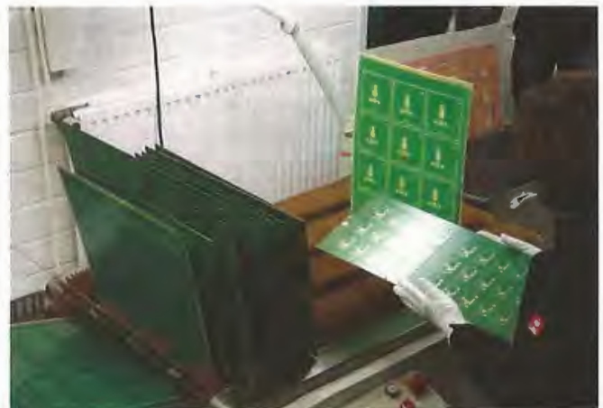
Die Vielfalt der Produkte und Verfahren stellt besondere Anforderungen an ein ERP-System – hier Platinen nach dem Bürsten.
