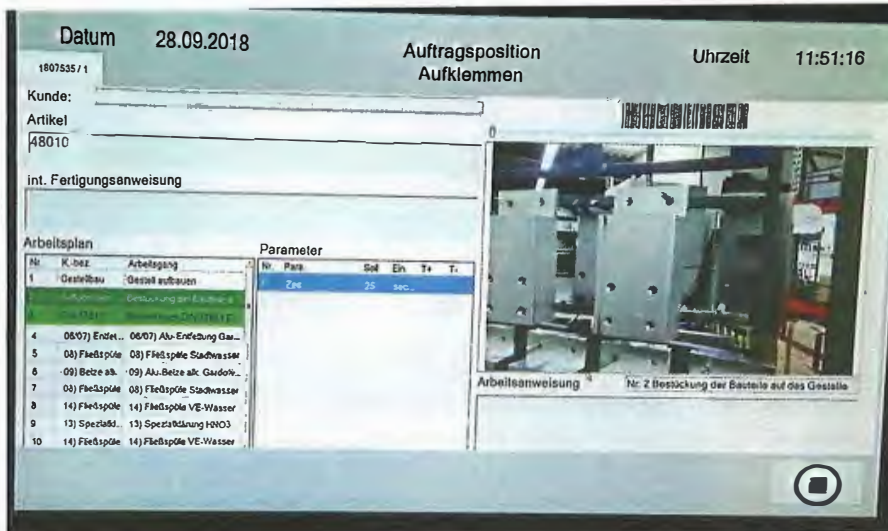
Die OTEC-Software bietet die Möglichkeit, über hinterlegte Bilder exakt die Bestückung eines Gestells vorzugeben und anschließend bei Bedarf auch zu dokumentieren.
